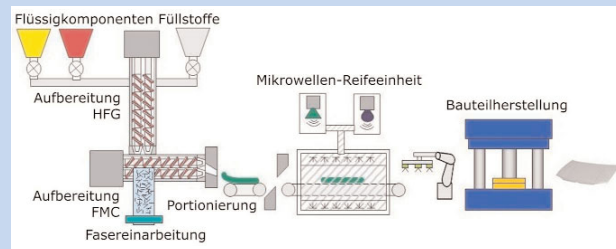
Schematische Darstellung des Direktprozesses für SMC
