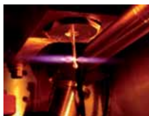
Blick in die Vakuumkammer: Von oben ragt ein mit Helium gefülltes Röhrchen in den Raum. Wird es von einem Laserblitz (violett) durchquert, entstehen dabei extrem kurze Röntgenpulse. Foto: József Seres
