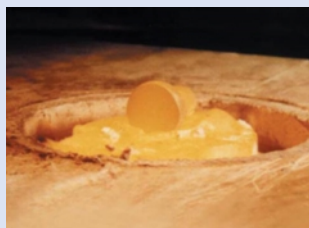
Isothermgesenk mit geschmiedetem Bauteil (Quelle: ThyssenKrupp Turbinenkomponenten)
